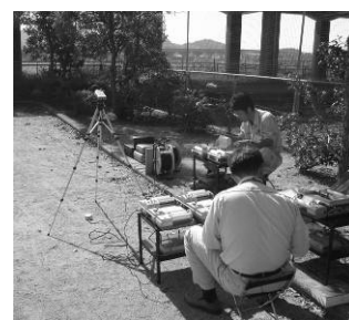
新幹線騒音振動測定
