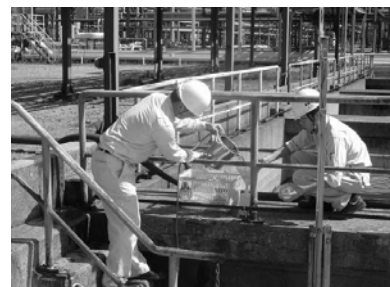
工場排出水の採水
