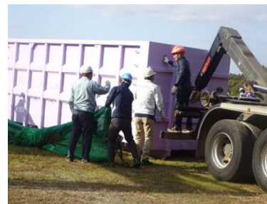
バツカンをアームロール車に 連結させている様子
