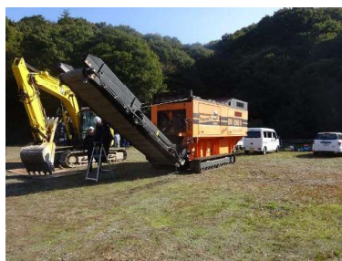
木製家具等を破碎するための 破碎機 (訓練では使用していない)
