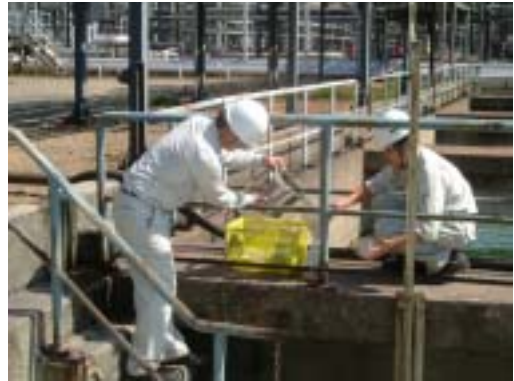
工場排出水の採水
