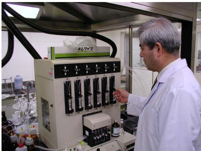
固相抽出装置を利用した検査試料の濃縮
