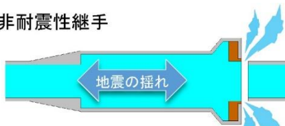
耐震管の仕組み
