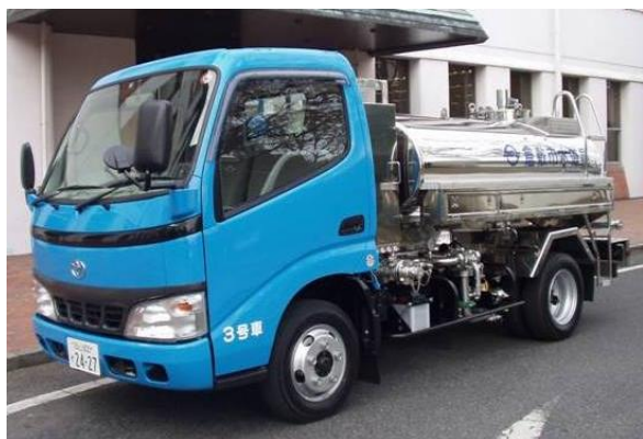
給水車(2tクラス)5台
