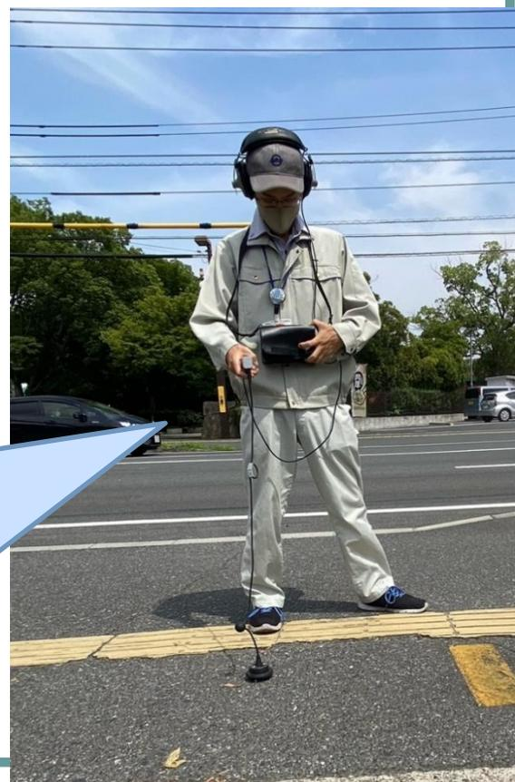
漏水探知器による漏水調査の様子
