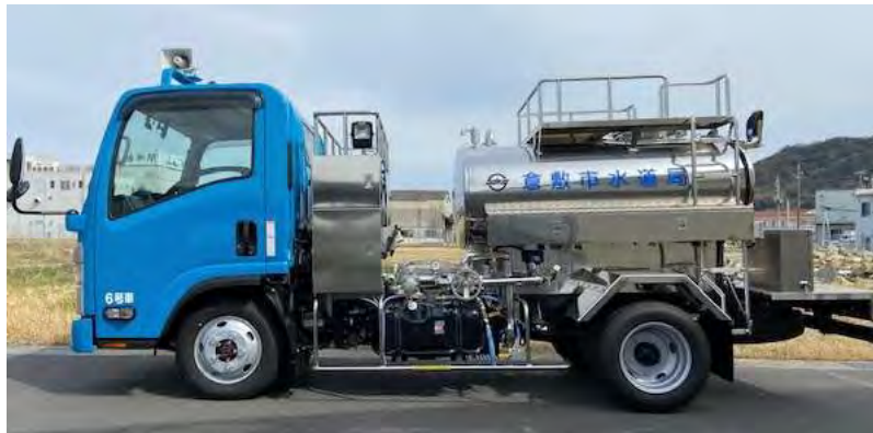
4WD中型給水車(2tクラス)
