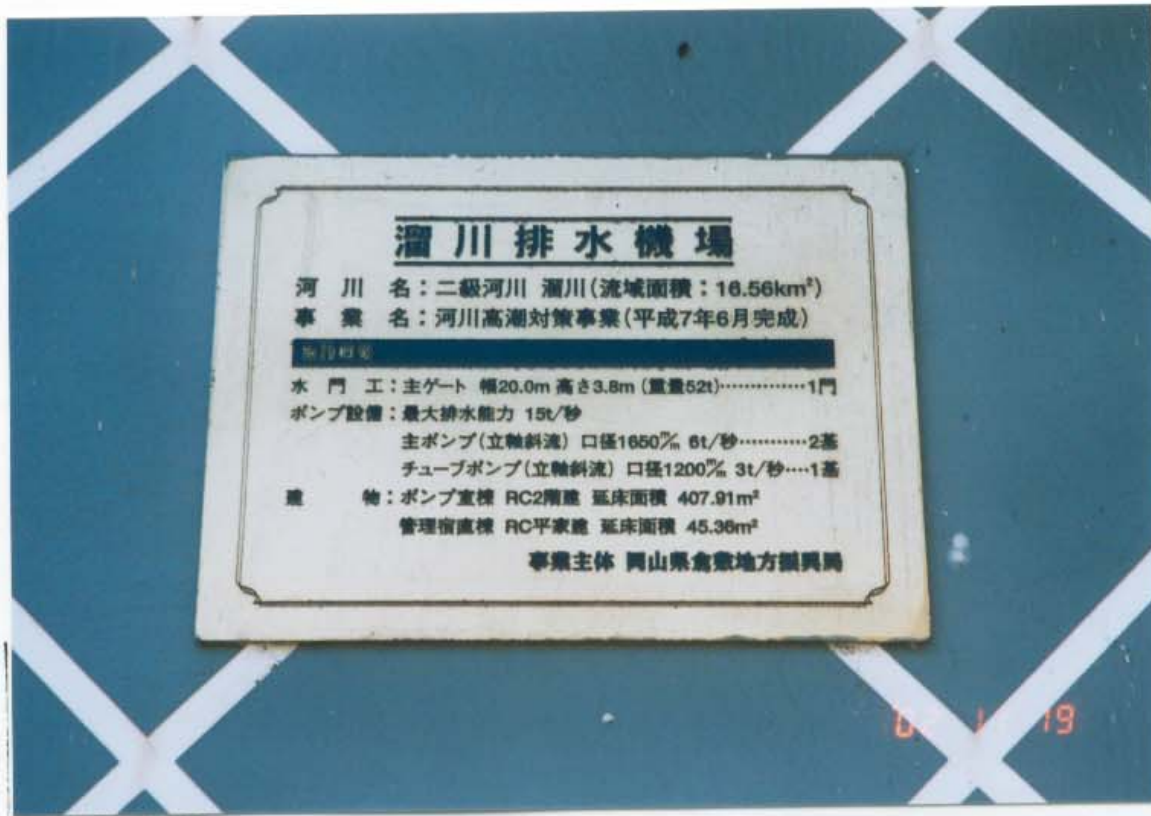
写真上……溜川排水機場(蔵屋敷風水門)の設備概要のプレート 94～96ページ 蔵屋敷風水門参照
