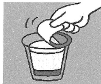
の部分は、ぬらすことで液体の接着剤になり、やがて固まります。つまり、接着剤に含まれる水分や溶剤が蒸発することで、接着剤が液体から固体になる点で共通しています。また、アイロンでくつつけるタイプのアップリケ(注2)の場合は、固まっていた接着剤がアイロンの熱によって溶けていったん液体になり、それが冷えて固体になることでくつつきます。このように、熱を加えて接着剤を一度溶かし、その後、液体が冷えて固まることでくつつく接着剤をホットメルト接着剤といいます。他にも、液体が化学変化を起こして固体になるものがあります。例えば、瞬間接着剤はその一例です。物の表面には、乾いているように見えてもわずかに水分が含まれています。また、空気中にも水分が含まれています。瞬間接着剤は、それらの水分に反応し、非常に速いスピードで固体に変化するのです。
