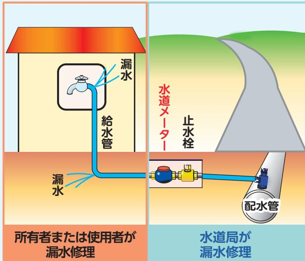
水道メーターより自宅側で漏水が発生した場合は、以下の点に注意して「倉敷市指定給水装置工事事業者」へ修理を依頼してください。
