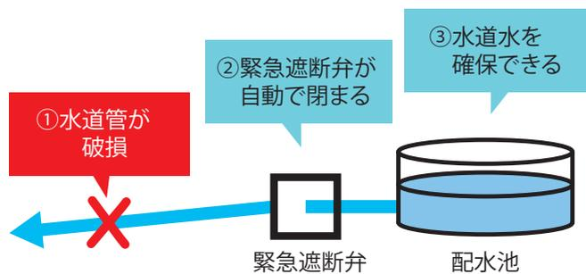
▲水道水の流出を防止するしくみ
