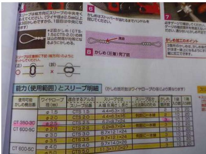
取付けるワイヤー径のかしめ箇所数を確認する
