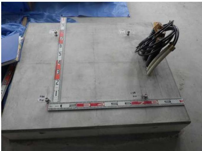
耐震計算書記載のアンカーボルトピッチになっていることがわかるように写真を撮影する
