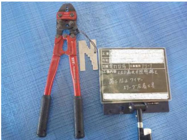
照明付属品以外のワイヤーで取り付ける場合は、かしめ方法が適正であることがわかるように写真を撮影する
