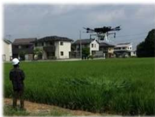
ドローンによる農薬散布 地上からの散布に比べ、作業時間が短縮できます
