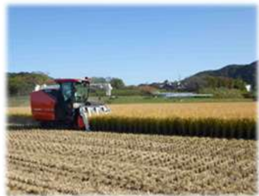
自動操舵機能の付いたコンバイン 狭小不整形の農地*では、大型の自動操舵機械の利用は困難ですが、農地を大区画化*することで利用しやすくなり、省力化を図ることができます
