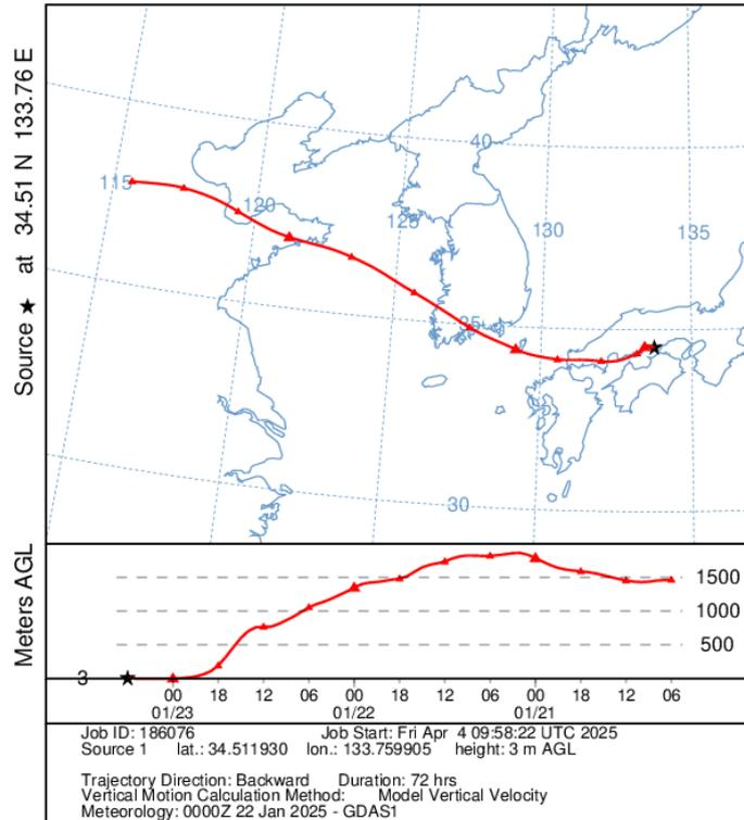
図8(1) 後方流跡線解析図（観測地点高度：3m NOAA HYSPLIT MODEL）
