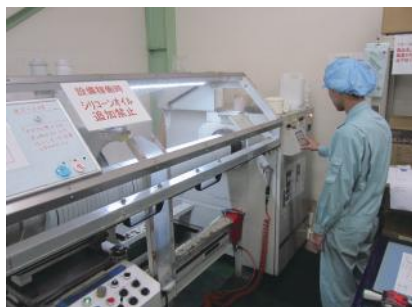
粘着テープのロールを裁断する際、角度調整などの改善を重ねることで幅精度が上がり、廃棄を削減。
