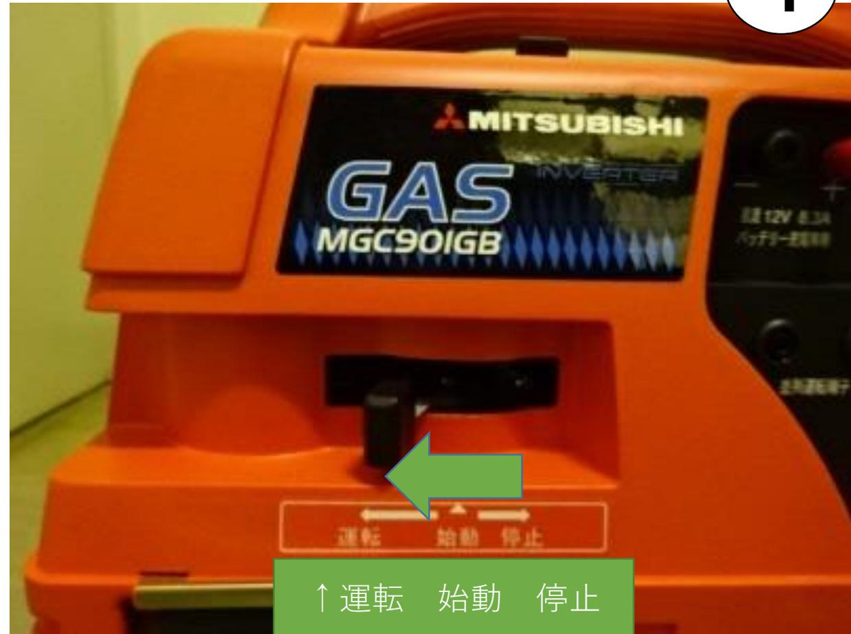
始動後2分ほどして音が安定したら『始動』から『運転』に移す。電気の供給が開始される。
