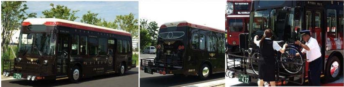
◆自転車からバス、バスから自転車の利用のための自転車搭載型バス
